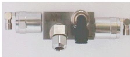
Jedem Eingang ist ein pneumatisch steuerbares Ventil zugeordnet. Aufgrund der alternierend angesteuerten Ventile können sich die Öffnungszeiten der Ventile überschneiden. Deshalb enthalten die Anschluss-Verschraubungen beider Eingänge (Druckluft und Lösemittel) zusätzlich je ein Rückschlagventil.
