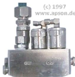
Jedem Eingang ist ein pneumatisch steuerbares Ventil zugeordnet. Zum Gewährleisten einer sicheren Funktion des Turbo-Puls Cleaners muss der Druck am Lösemittelleingang um ca. 1 bis 1,5 bar Greer sein als der Druck am Drucklufteingang. Deshalb enthält der Anschluss für den Drucklufteingang zusätzlich ein Rückschlagventil.
